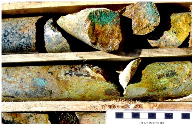
Рис. 2.14 - Смешанные руды с малахитом по кварц-сульфидной жиле. Содержание меди в пробе-1,4%. Скважина ВАІ- 9, глубина 27,5 м
