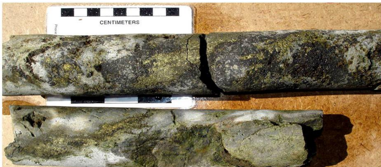
Рис. 2.19 - Кварц-сульфидное жильное образование с халькопиритом, пиритом, борнитом и вторичным халькозином. Скважина ВАІ-9, глубина 57,0 м; медь - до 7,2%; золото - 0,3 г/т.
