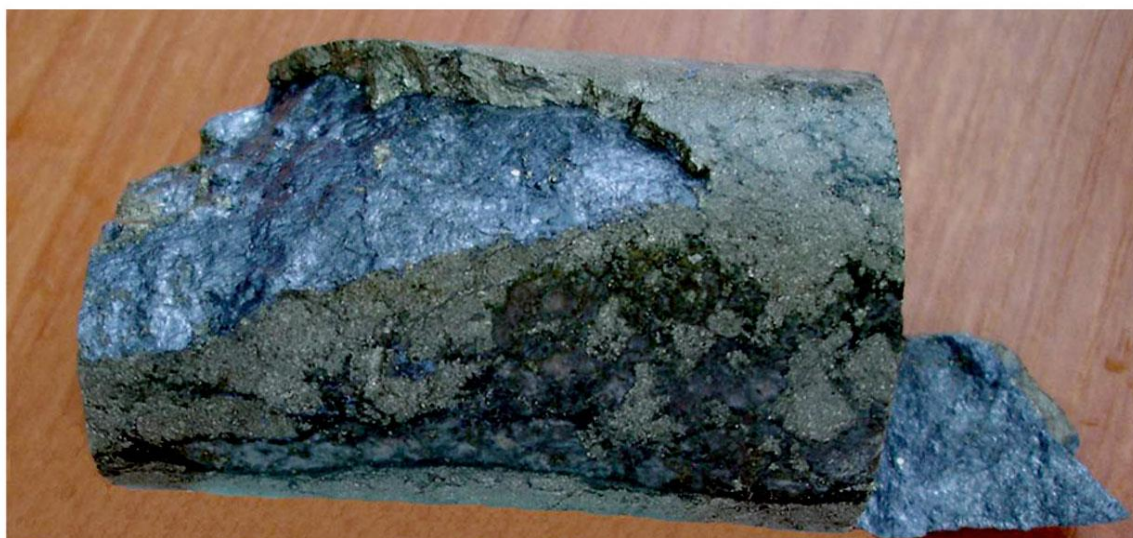
Рис. 2.27 - Пирит-халькопирит-молибденитовое жильное образование. Скважина ВАІ-1. Глубина 117,0 м; медь - 1,5%; молибден - 0,34%
