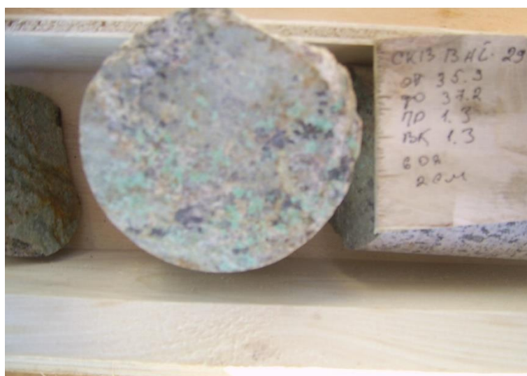
Рис. 2.15 - Малахитовые руды в гранодиоритах, по вкрапленным сульфидным рудам
