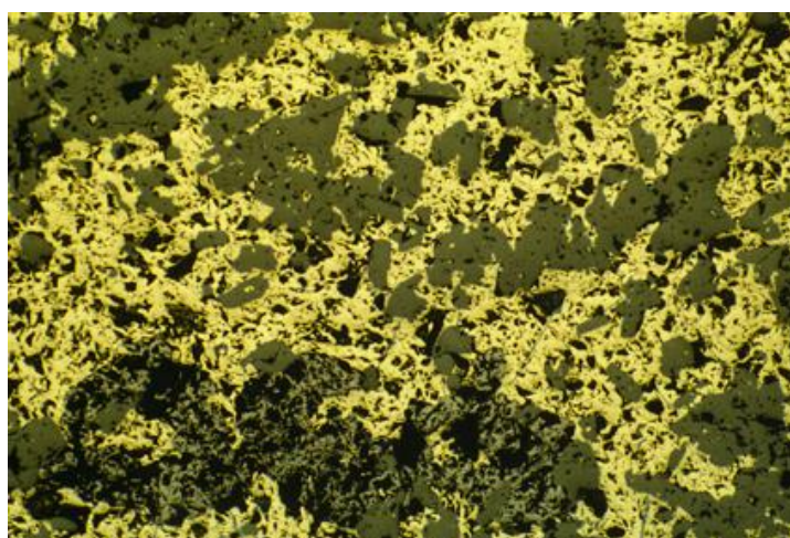
Рис. 2.23 - Халькопирит, выполняющий роль цемента обломков вмещающей оруденение породы. Внизу располагается вытянутый агрегат магнетита (темно-серый, ноздреватый)
