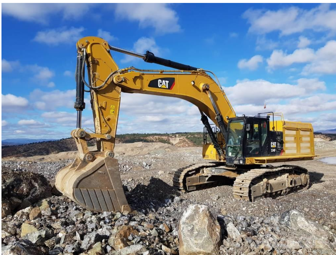
Рис. 5.10 Гидравлический экскаватор САТ-374 с ковшом 3,8 м 3
